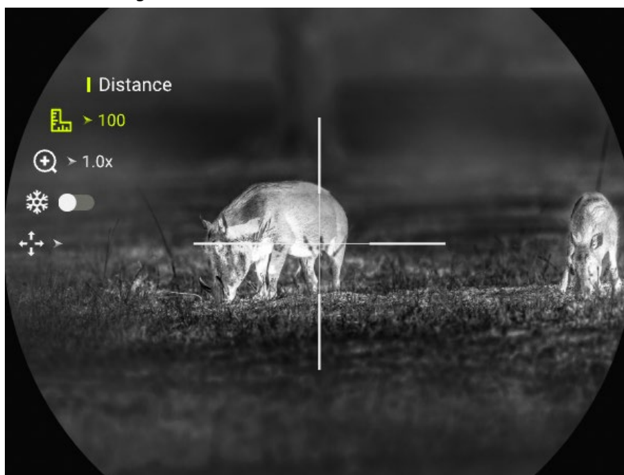
Figure 3-15 Nastavení záměrného bodu
